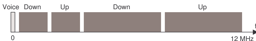
Abbildung 4: CAP/QAM mit je zwei separaten Bändern für Up- und Downstream (schematisch)
